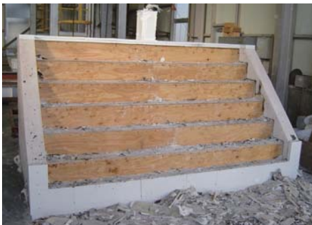
30分加熱し、約90分放冷した後、炉から取り出し耐火被覆材を除去して構造躯体を確認したが、炭化などの問題はない
