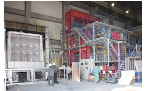
実験機関のひとつ 東京理科大学 火災科学研究中心 実験棟の実験施設 左端が壁体を試験する大型炉
