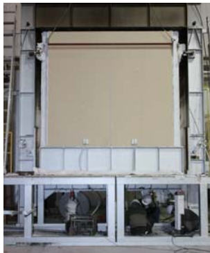
大型炉に試験体を設置したところ
