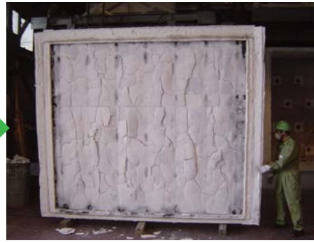
加熱後① 60分加熱し、約180分放冷後、炉から取り出したところ。木製サイディングは落ち、内部の耐火被覆面が露出している
