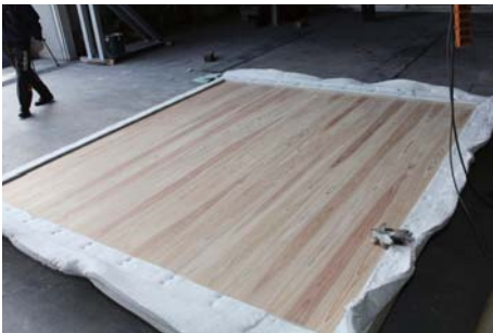
加熱前の試験用壁体
