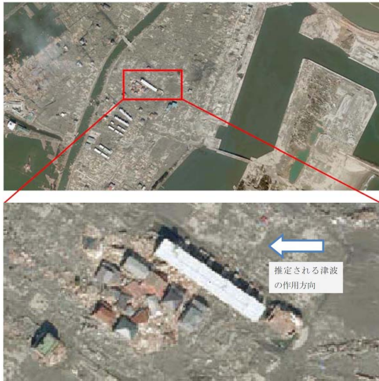
写真 6.4.3-4 津波の作用方向の前面に建つ建築物により津波波力が軽減し、残存したと考えられる例（名取市関上地区）
