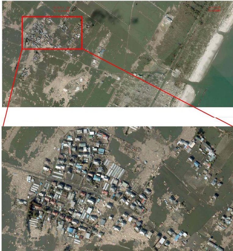
写真 6.4.3-3 最大浸水深が低いため、残存している事例 (仙台市若林区荒浜地区)
