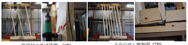
桝組材の曲げ破壊 (3R) 土台のせん断割裂 (7R)
