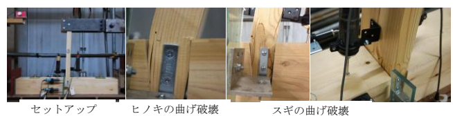
図2 試験体の設置の様子と破壊性状
