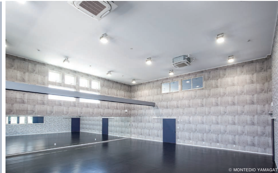
広さ約35坪(11m×11m)で、吹抜けの天井高が約5.5mの大空間の屋内トレーニングルーム。壁2面が鏡張りになっている。梁はトレーニングチューブを吊り下げることが想定されている。
