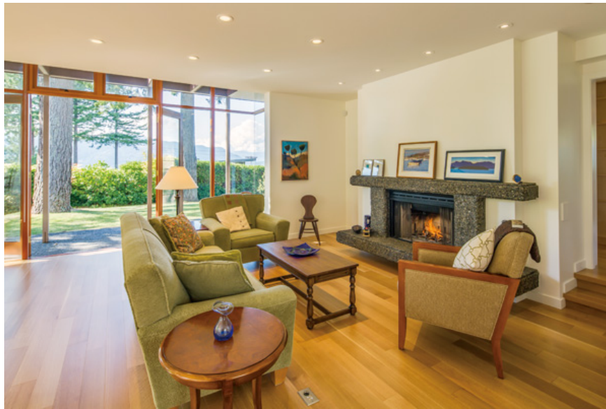
リビングは西側に配置され暖炉が設けられている。庭に接するように床レベルが低く設定され、内外が一体化する設計となっている。
