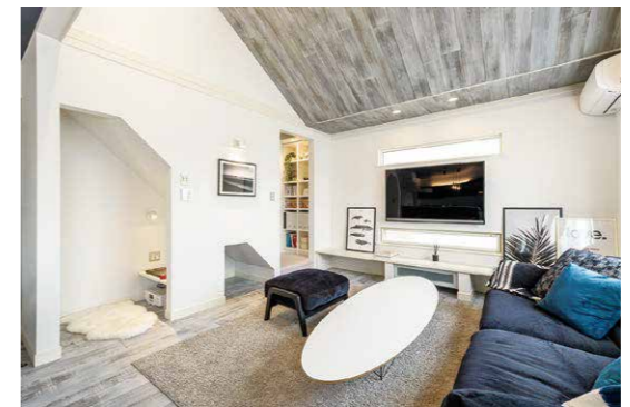
2階の子世帯のLDK。元々のLDKと洋室をつなげ開放感のある空間に。床と勾配天井にビンテージ感漂うオーク材を使用。リビングは壁掛けテレビに合わせて窓をつくり替え。その脇の書棚の所にロフトへの階段がある。
