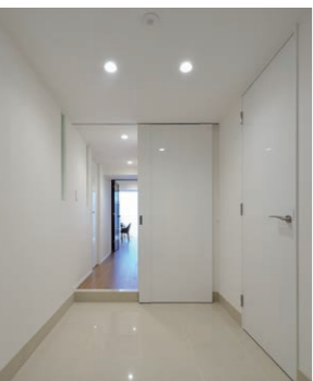
車いすを置く広さを確保した玄関の例。
