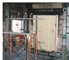
写真1 せん断変形試験後の載荷加熱試験状況
